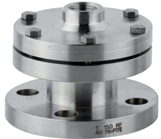
Realizados para aislar el elemento sensible de manómetros, presostatos, transmisores electrónicos de presión, de fluidos de proceso corrosivos, viscosos, sedimentosos y con altas temperaturas y presión. Una membrana elástica, cerrada mecánicamente y puesta a prueba antifugas garantiza la separación del fluido de transmisión del de proceso.
